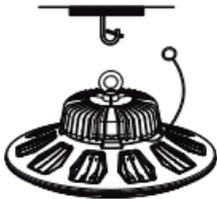
4. Instalar la lámpara y la cuerda de seguridad correctamente con los ganchos.
